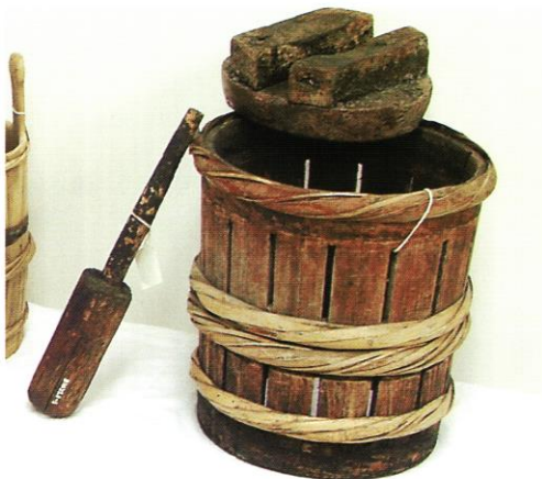
ジンドウ (45.5×43.0)・ 押し蓋 (32.5×12.5)・ 押し込み棒 (52.5×9.0) 粉碎した柿渋を入れ、圧搾するとき使用。隙間から渋液が出てくる。
